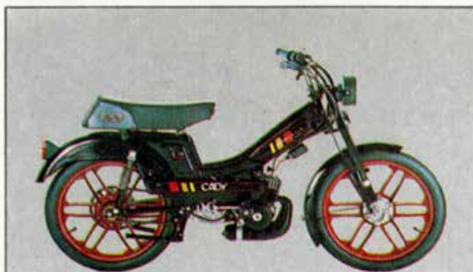
MOBYLETTE - Cady - (E) Precio: 84.800 Ptas. C.C.: 49,9 - CV-rpm: 1,8-5000 - Peso: 48 Kg.
